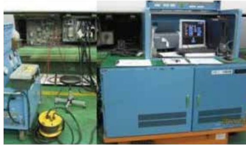
写真2：全検ブレーキ制御装置試験
