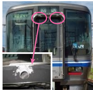
写真2：損傷したパッキン
