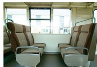
車両設計時には、使用から廃棄までのライフサイクル全体に配慮しています。車体や車輪などはほとんどリサイクルされますが、リサイクル率をさらに高めるため、新型車両導入時には、車両の腰掛詰物を従来のウレタン系の材質から、リサイクル可能なポリエステル系の材質に変更しています。
