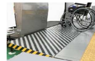
車両乗降時の段差解消に向けた車いす段差解消機構
