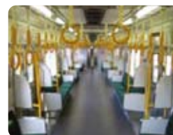
吊り手の形状、袖仕切りの大型化(205系)
