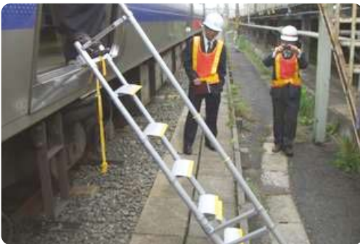
車両から避難するための手すり付梯子
