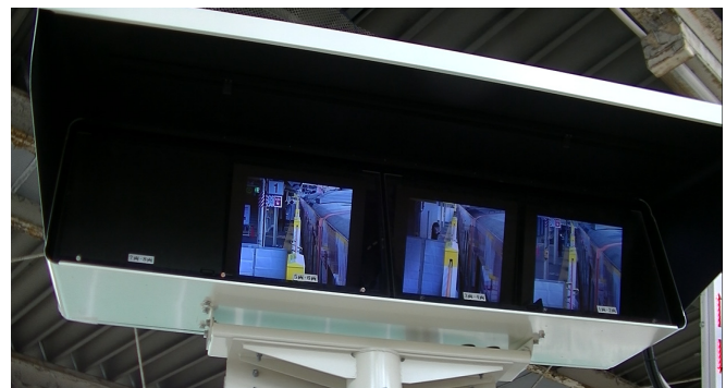
図5 3画面+目視時の ITV モニター
