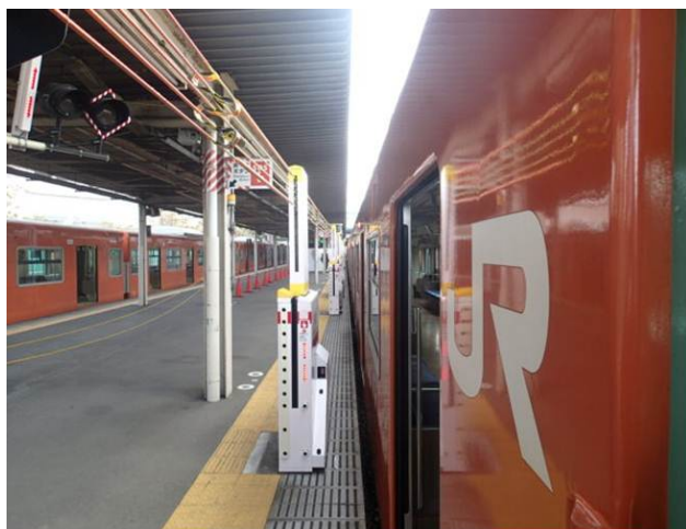
図 1 昇降式ホーム柵（ロープ上昇時）
