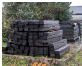
材料交換で発生した古い木まくらぎ
