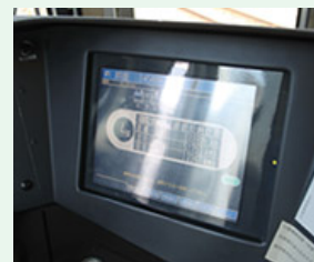
電力消費量がチェックできる223系の運転台モニター
